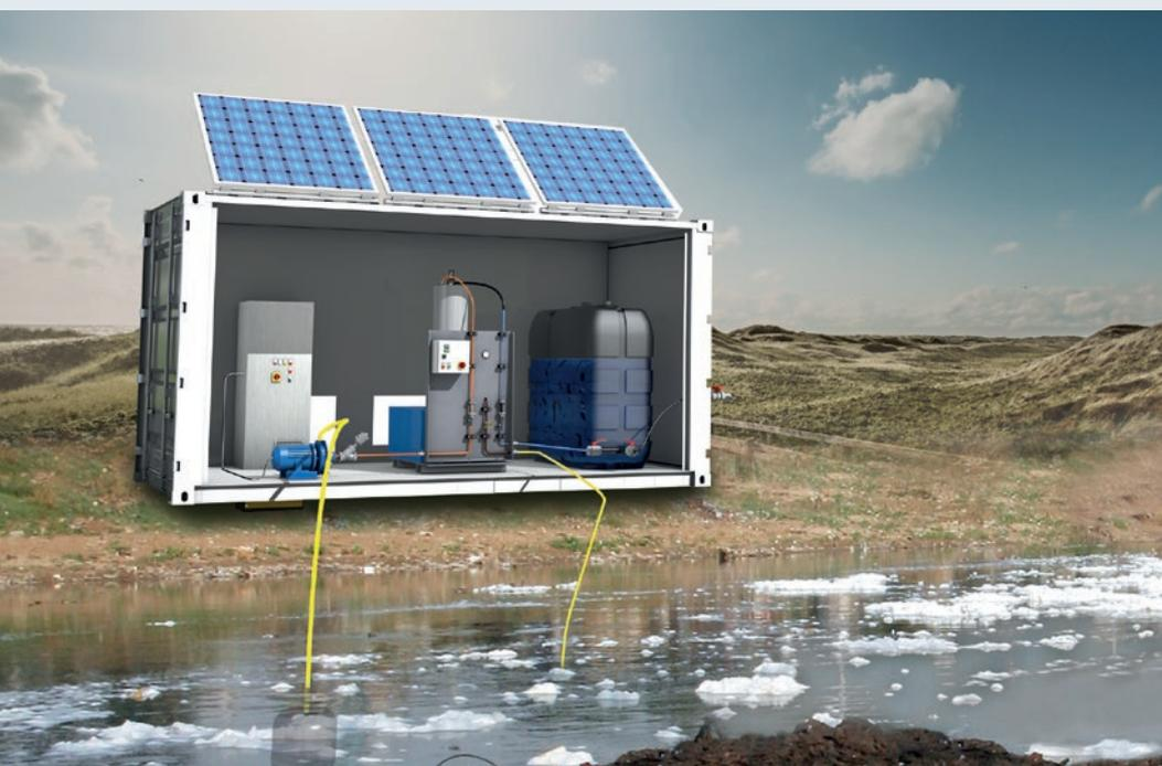
Das Filtrat, welches nach der Ultrafiltration frei von Bakterien und Viren ist, wird anschließend zur Abscheidung von Schwermetallen, Pestiziden und Medikamentenrückständen durch einen Aktivkohlefilter geleitet und in einem Reservoir für die Entnahme zur Verfügung gestellt. Der nicht gefilterte Teil wird dem Fluss wieder zugeführt. Die Anlage soll 5000 l Trinkwasser / Tag produzieren.
